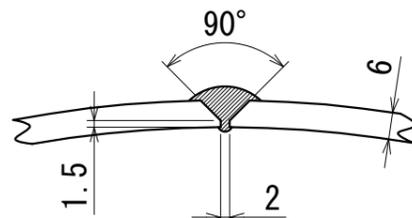
長手継手溶接部詳細図
