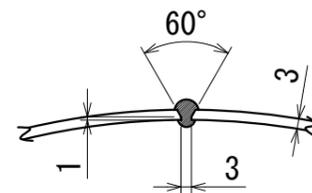
長手継手溶接部詳細図
