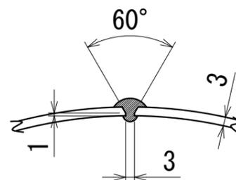
長手継手溶接部詳細図
