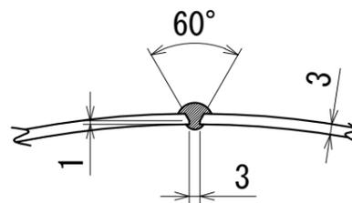
長手継手溶接部詳細図
