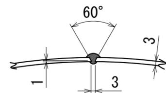
長手継手溶接部詳細図
